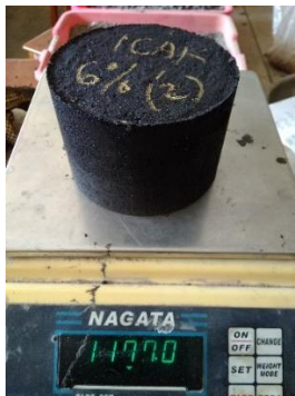
Gambar 3.c Proses penimbangan berat benda uji kering 6%
