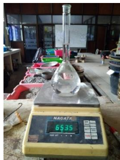
Gambar 1.c Proses penimbangan piknometer + air
