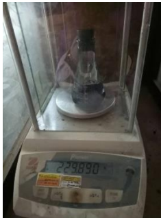
Gambar 2.b Proses penimbangan piknometer + air + benda uji
