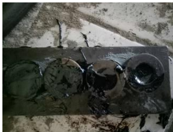
Gambar 2.e Benda uji pengujian Titik Lembek Aspal
