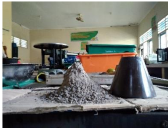
Gambar 1.e Kondisi agregat halus SSD
