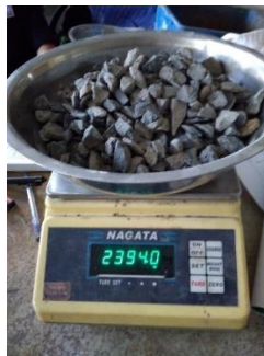
Gambar 1.b Proses penimbangan agregat
