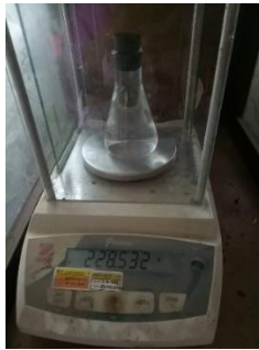
Gambar 2.a Proses penimbangan piknometer + air
