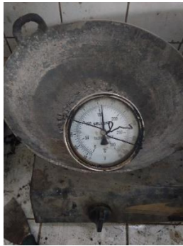
Gambar 3.a Proses memanaskan agregat
