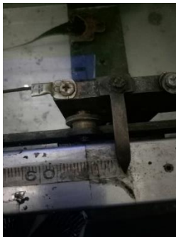
Gambar 2.c Proses pengujian Daktilitas Aspal
