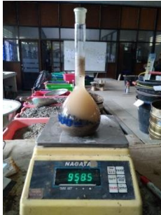
Gambar 1.d Proses penimbangan piknometer + air + benda uji
