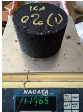
Gambar 3.d Proses penimbangan berat benda uji kering 0%
