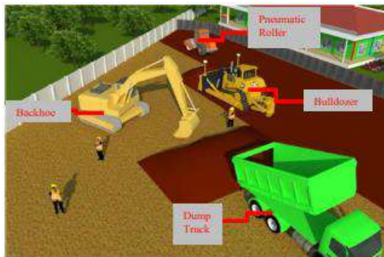
Gambar 10. 3 Pekerjaan Urugan Dan Pemadatan Tanah
