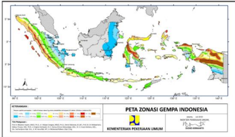
Gambar 3. 3. Peta respon spektra percepatan 1,0 detik ( S_1 ) di batuan dasar ( S_b ) untuk probabilitas terlampaui 2% dalam 50 tahun.
