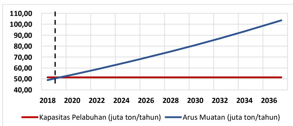
Gambar 5.41 Analisis Makro Kapasitas Dermaga – Proyeksi Arus Muatan (juta ton)
