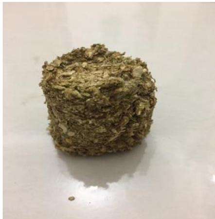
Gambar 4. 12 Spesimen Uji Knduktivitas Termal (90% - 10%)
