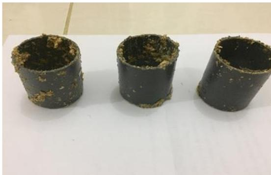
Gambar 3. 8 Cetakan dari Pipa PVC
