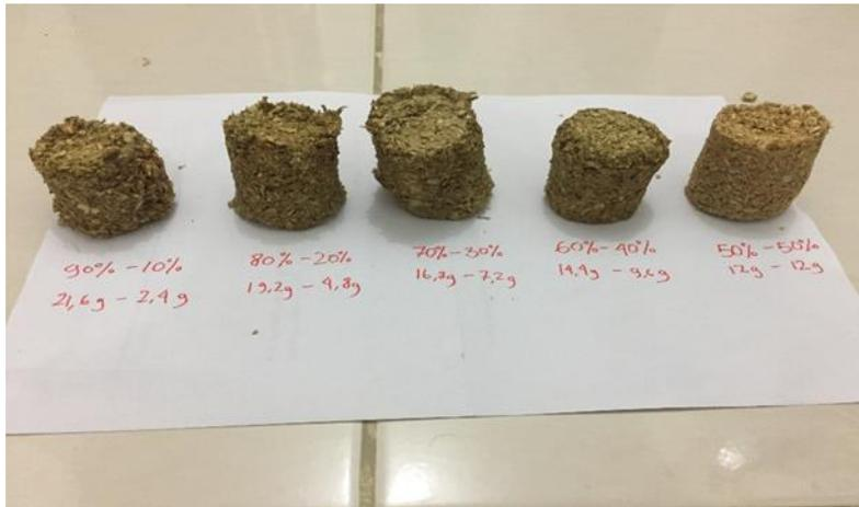
Gambar 4. 7 Spesimen untuk Pengujian Konduktivitas Termal
