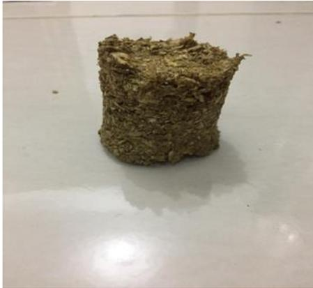
Gambar 4. 11 Spesimen Uji Konduktivitas Termal (80% - 20%)
