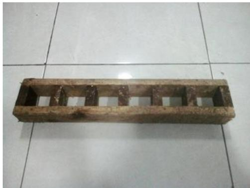
Gambar 3. 6 Alat Pencetak Spesimen Massa Jenis
