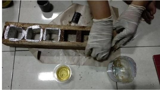
Gambar Proses Pembuatan Spesimen Massa Jenis
