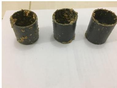
Gambar Alat Cetak Spesimen Konduktivitas Termal
