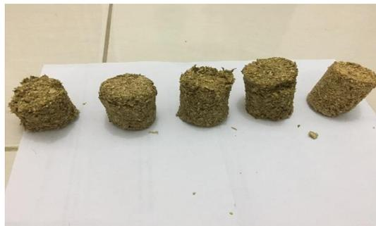
Gambar Spesimen Konduktivitas Termal
