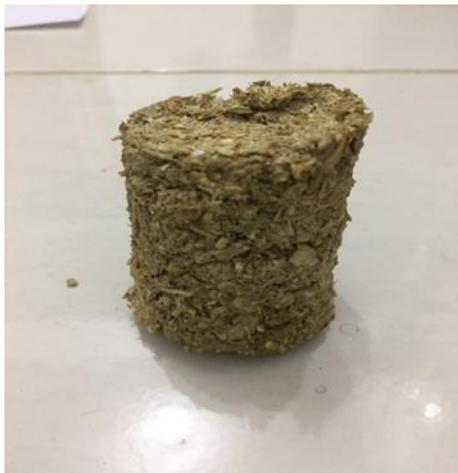
Gambar 4. 10 Spesimen Uji Konduktivitas Termal (70% -30%)
