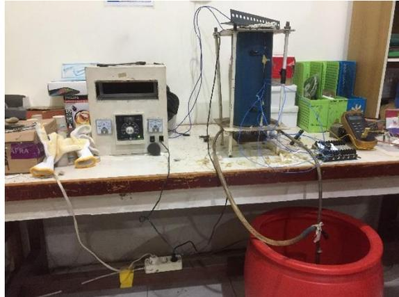
Gambar Alat Pengujian Spesimen Konduktivitas Termal
