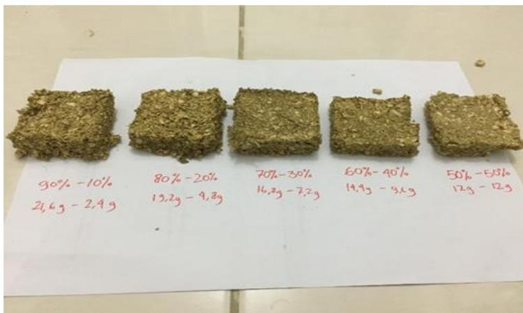
Gambar 4. 1 Spesimen untuk Pengujian Massa Jenis
