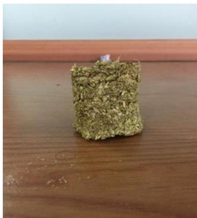
Gambar 3. 7 Spesimen Uji Konduktivitas Termal
