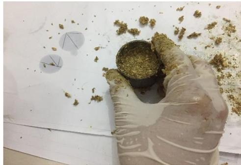
Gambar Proses Pembuatan Spesimen Konduktivitas Termal
