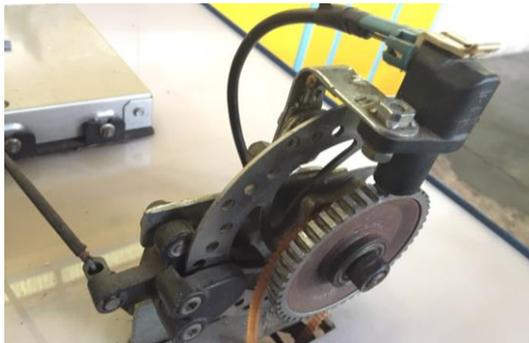
**Gambar 2. 3** Sensor Kecepatan Roda dan *Reluctor Ring*
