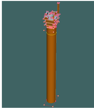
Gambar 4.1. Permodelan numeris Neptune Spar dengan Maxsurf Hull Modeller
