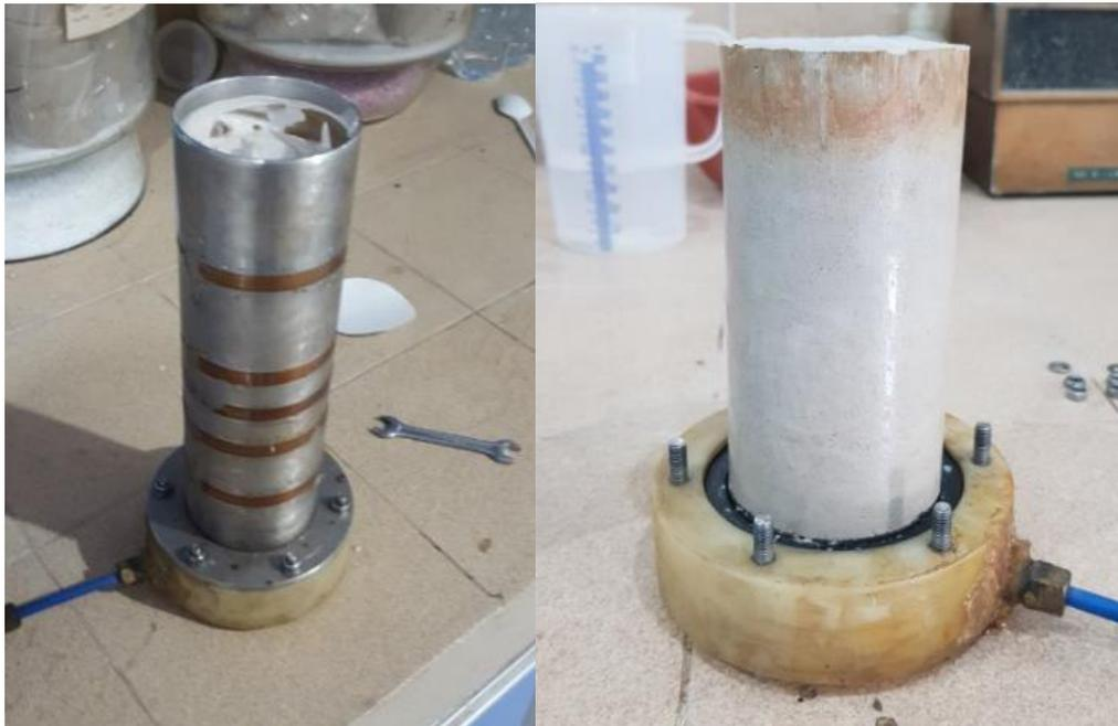
Gambar 3.5 Tabung konsolidometer dan benda uji hasil *remoulded*
