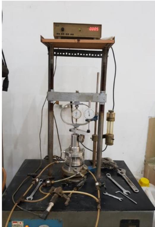
Gambar 3.3 *Loading Frame* Marui yang digunakan dalam penelitian
