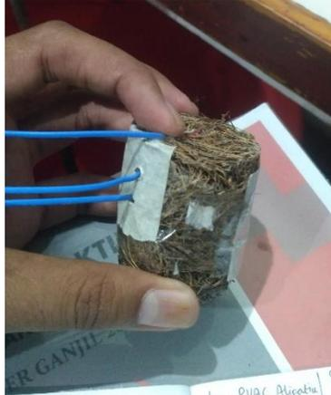
Gambar 3. 12 Peletakan termokopel pada spesimen uji
