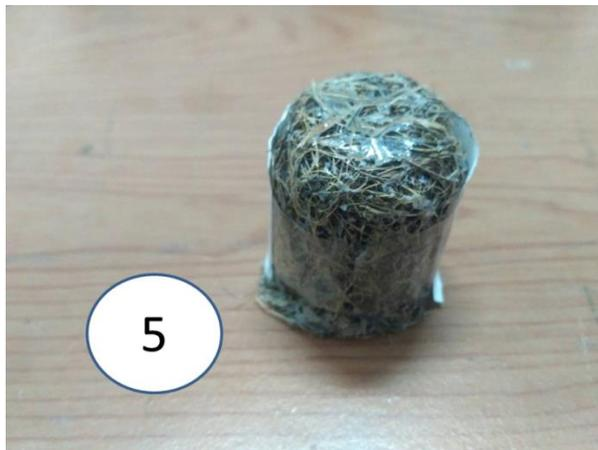
Gambar 4. 14 spesimen uji konduktivitas termal 5
