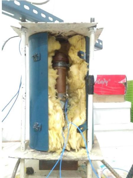
Gambar 3. 14 Alat uji konduktivitas termal yang akan ditutup rapat
