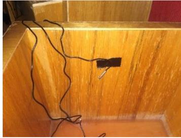
Gambar 3. 27 Lokasi sensor suhu pengukuran
