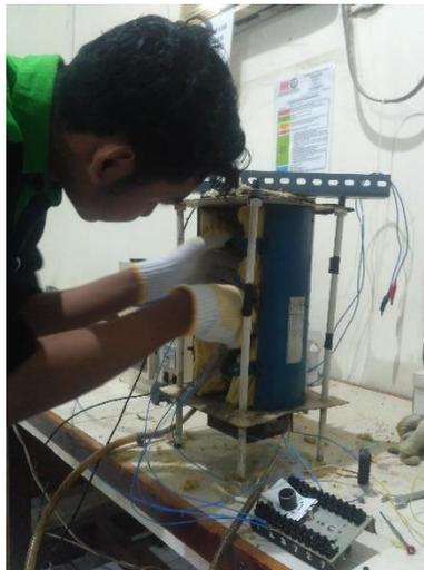
Gambar 3. 13 Peletakan spesimen uji pada alat uji oleh teknisi
