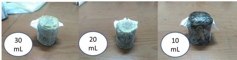
Gambar 4. 1 Uji coba penentuan komposisi lem polyurethane
