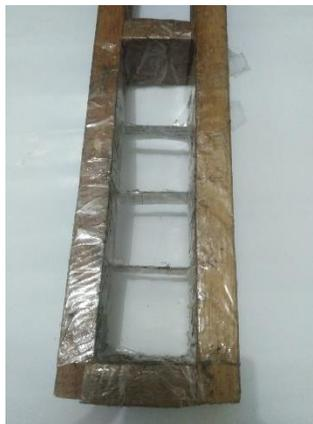
Gambar 3. 5 Cetakan spesimen massa jenis
