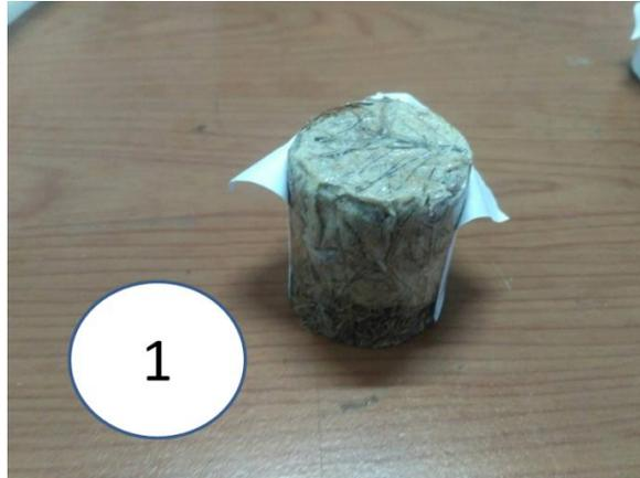
Gambar 4. 10 Spesimen uji konduktivitas termal 1
