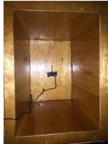
Gambar 3. 25 Sensor pengukur suhu air es
