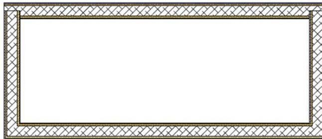
Gambar 3. 17 Ilustrasi *coolbox* insulasi serat ijuk dan sabut kelapa
