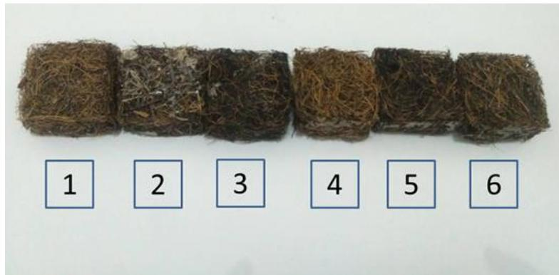
Gambar 4. 2 Spesimen uji massa jenis
