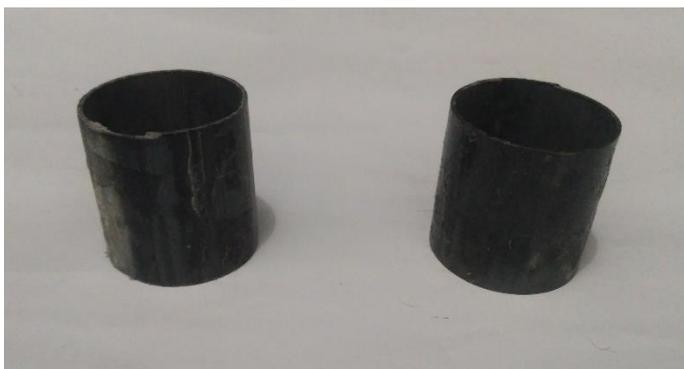
Gambar 3. 7 Cetakan spesimen konduktivitas termal
