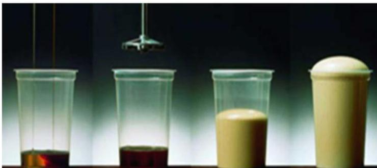
Gambar 2. 7 Tahapan ekspansi *polyurethane*
