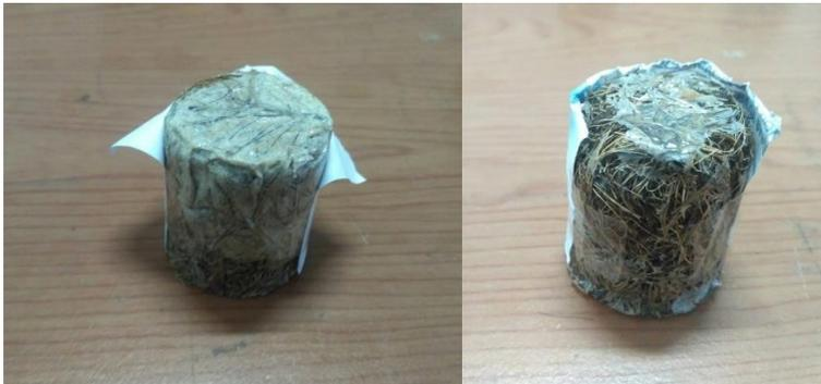
Gambar 3. 8 Spesimen 1 dan 4 untuk uji konduktivitas termal
