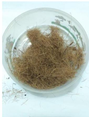
Gambar 3. 3 Serat sabut kelapa yang telah dipotong
