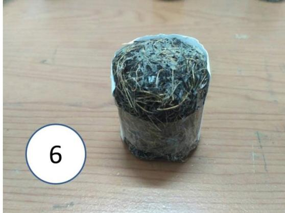
Gambar 4. 15 Spesimen uji konduktivitas termal 6
