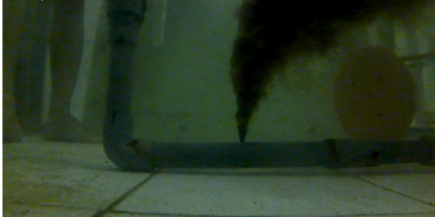
Gambar 5.5 Minyak yang keluar pada kebocoran ukuran 5 mm
