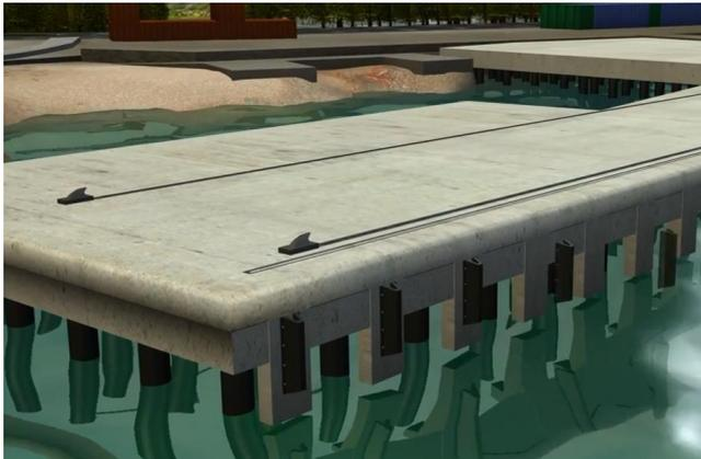
Gambar 7. 11 Pemasangan fender
