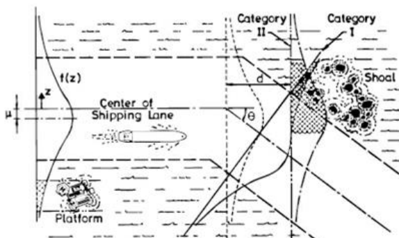
Gambar 2.7 Ilustrasi skenario kapal kandas Sumber: IALA
