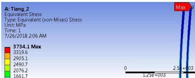
Gambar 4.9 Hasil Simulasi Berupa Tegangan Von Mises yang Terjadi pada Tiang dengan Lintasan Belok
