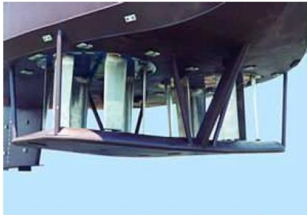
Gambar 2.9. Voith Sneider Propeller (Sumber : Sasono J, 2009)
