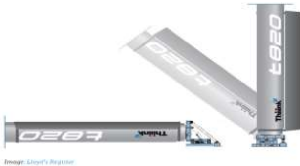
Gambar 2. 2 Ilustrasi Aplikasi Flettner Rotor pada Kapal Sumber. Lloyd's Register
