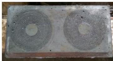
Gambar 3.37 Paving Block yang Telah Diauskan
