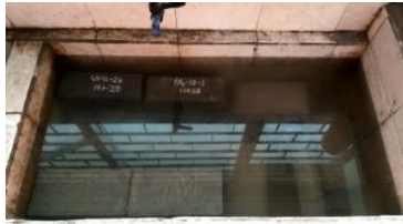
Gambar 3.38 Perendaman Paving di dalam Air
