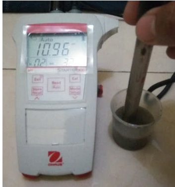
Gambar 4.17 Pengujian pH Menggunakan pH Meter
