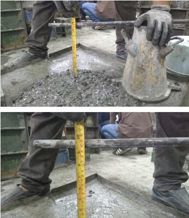
Gambar 4.14 Pengujian Slump Beton Geopolimer 12M Air Laut
