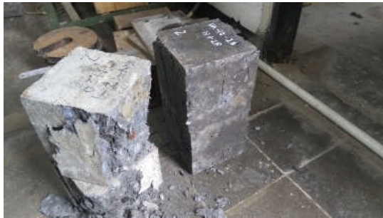
Gambar 3.34 Beton Setelah Diuji Tekan
