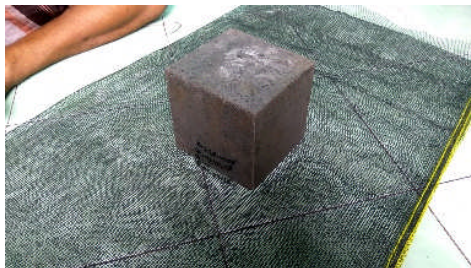
Gambar 3.21 Beton Diletakkan di Atas Waring
