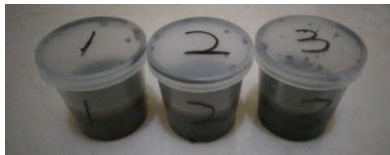
Gambar 3.48 Benda Uji yang Telah Ditambah Air Suling dan Diaduk
