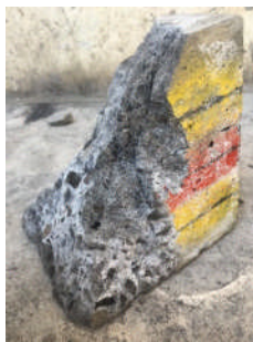
Gambar 3.43 Sisa Beton yang Telah Dihancurkan dan Diambil Sampel Per Kedalaman
