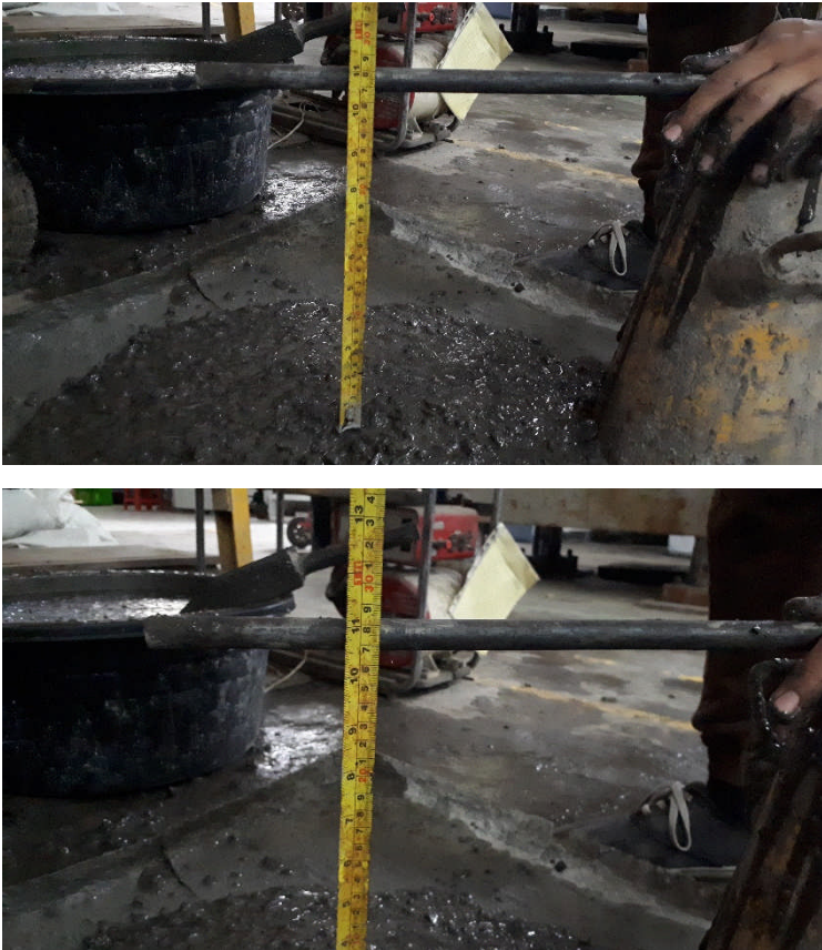
Gambar 4.16 Pengujian Slump Beton Geopolimer 10M Air Laut
