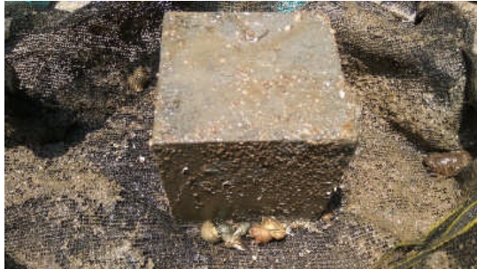
Gambar 3.27 Kondisi Beton Setelah Dibuka dari Waring
