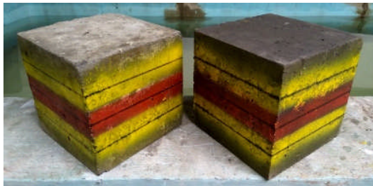
Gambar 3.31 Beton yang Telah Diberi Warna Per Kedalaman
