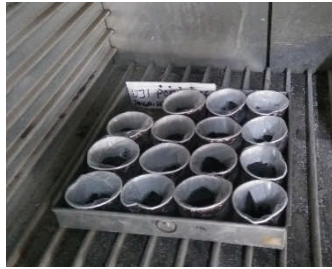
Gambar 3.45 Benda Uji Dimasukkan ke Dalam Oven
