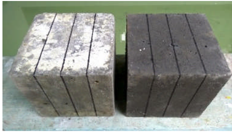
Gambar 3.30 Beton Digarisi untuk Memberi Tanda Per Kedalaman
