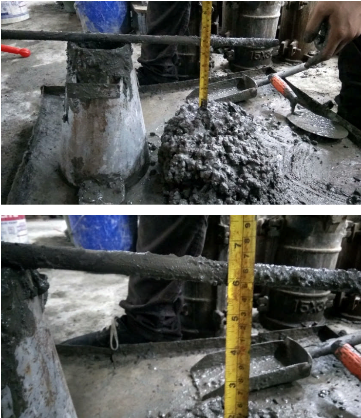
Gambar 4.12 Pengujian Slump Beton OPC
