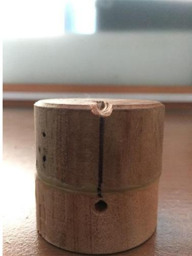
**Gambar 3. 19 Spesimen uji konduktivitas termal 1**
