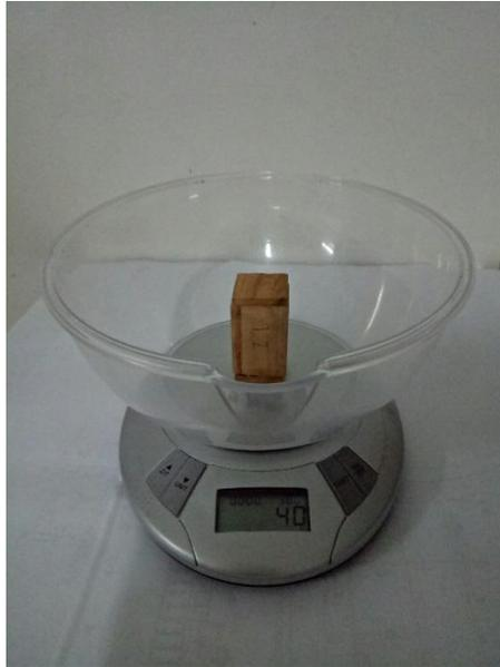
**Gambar 4. 1 Pengukuran massa sampel insulasi 80% : 20%**
