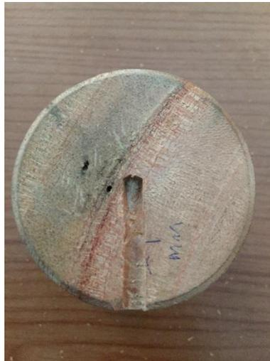
**Gambar 3. 20 Spesimen uji konduktivitas termal 2**
