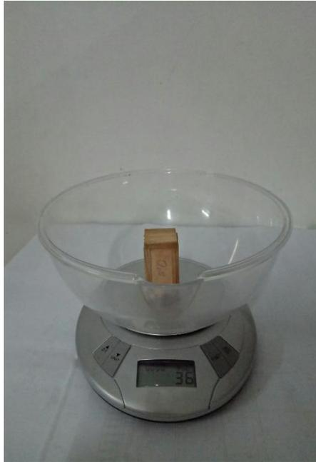
**Gambar 4. 5 Pengukuran massa sampel insulasi 20% : 80%**
