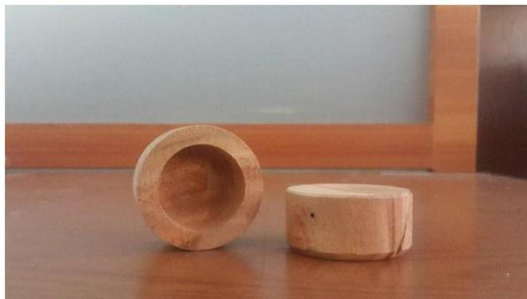
**Gambar 3. 10 Potongan akhir kayu untuk uji konduktivitas termal**
