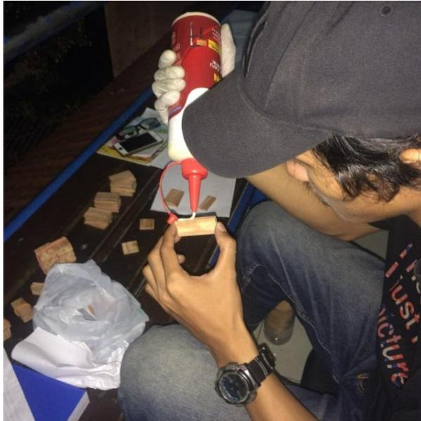
**Gambar 3. 7** Pemberian lem PVAc pada satu sisi kayu
