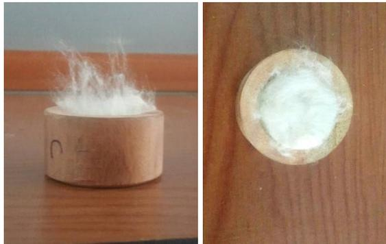
**Gambar 3. 13 Pemadatan serat kapuk untuk uji konduktivitas termal**
