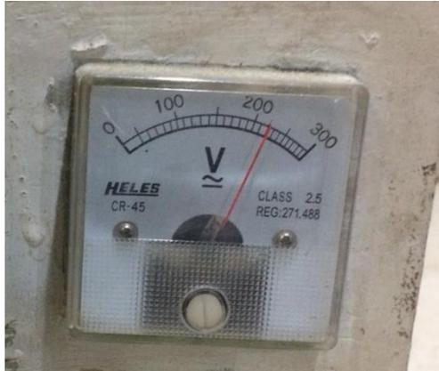
**Gambar 3. 25 Voltmeter yang ada di *thermocontrol***
