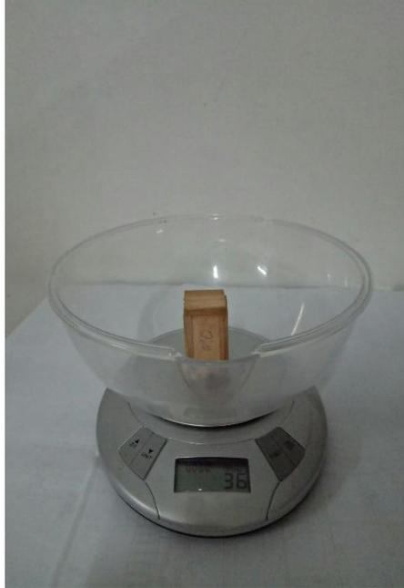
**Gambar 4. 2 Pengukuran massa sampel insulasi 60% : 40%**
