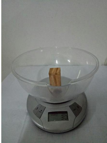
**Gambar 4. 4 Pengukuran massa sampel insulasi 40% : 60%**
