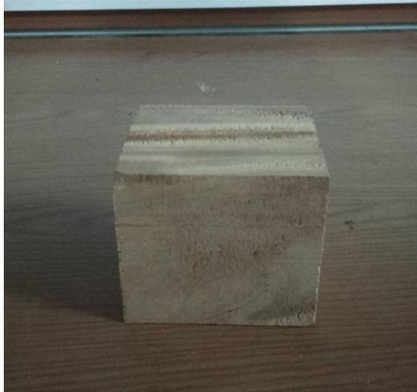
**Gambar 3. 9 Potongan awal kayu untuk uji konduktivitas termal**
