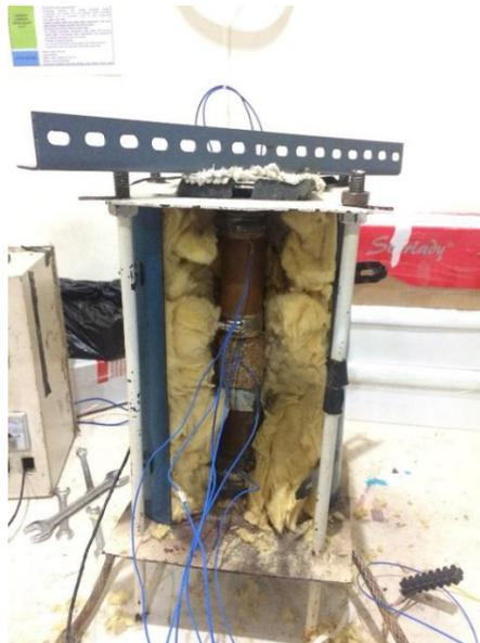
**Gambar 3. 16 alat uji konduktivitas termal**
