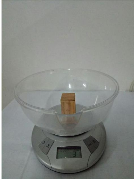
**Gambar 4. 3 Pengukuran massa sampel insulasi 50% : 50%**
