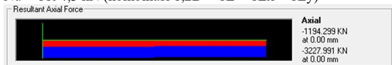
$$\bar{O}Vc = 0,75 \times 0,17 \left( 1 + \frac{1194,3}{14 \times 600^2} \right) 1 \sqrt{35} 750 \times 686 = 491,9 \text{ kN}$$
