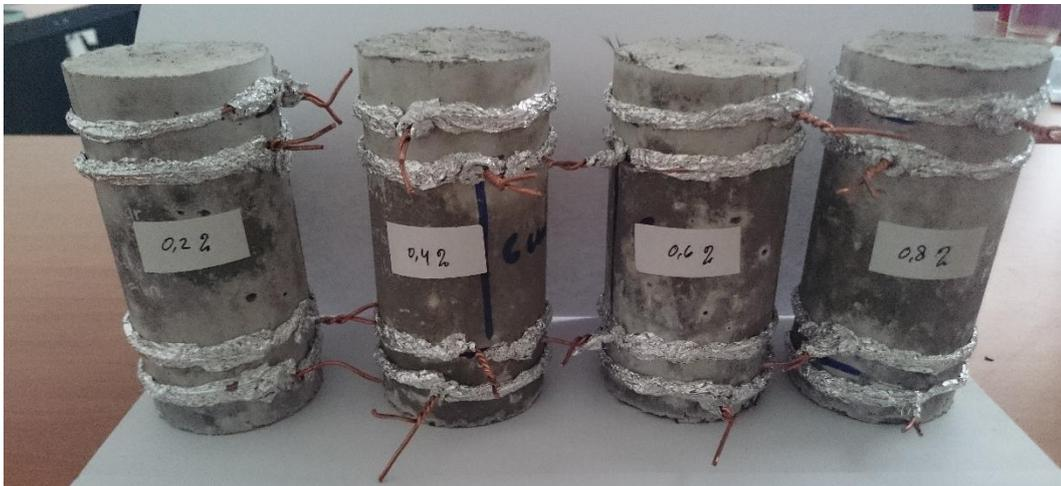
Gambar 4. 9. Sampel beton berpenguat serat karbon dengan variasi berat serat karbon (0.2, 0.4, 0.6, 0.8)% berat dengan 4 elektroda tembaga.
