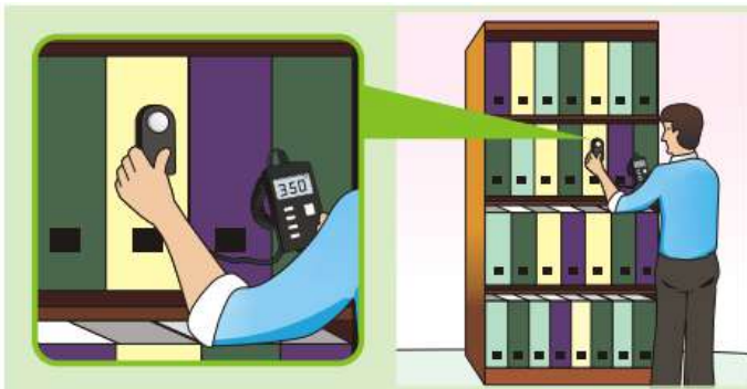
Gambar 3.6 Pengukuran Kuat Pencahayaan di Rak Buku
