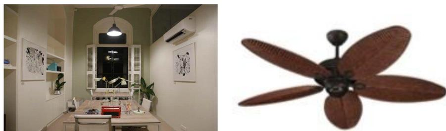
Gambar 4.12. Penghawaan mekanik dengan system Air Conditioning pada ruang yang tidak memiliki cukup ventilasi dan kipas angin pada ruang yang memiliki cukup ventilasi
