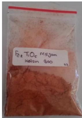
Gambar 4.6 Contoh sampel setelah kalsinasi pada temperatur 900^\circ\text{C}
