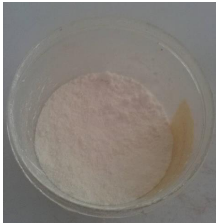
Gambar 4.3 Serbuk \text{TiO}_2 anatase komersial sebagai bahan dasar
