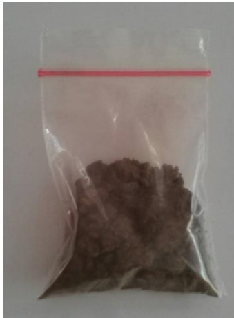
Gambar 4.1 Batu besi yang telah ditumbuk
