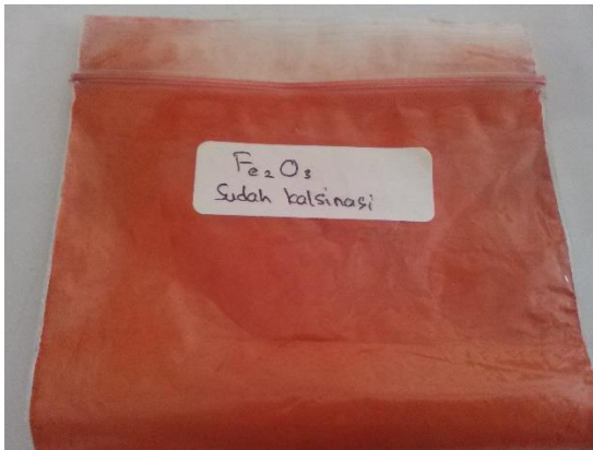
Gambar 4.2 Serbuk Fe 2 O 3 hasil sintesis
