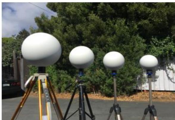
Gambar 2.4 *Sphere* yang didirikan di atas statif Faro 2009
