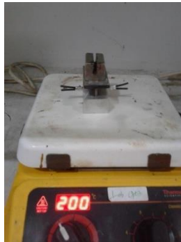
Gambar 3.10 Proses pengandengan serat optik
