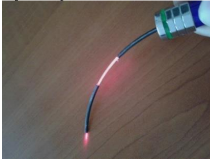
Gambar 3.6 Serat optik yang telah dihilangkan cladding -nya
