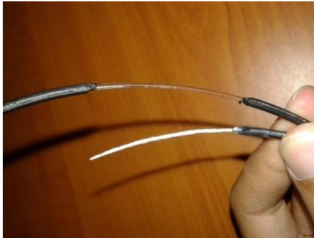
Gambar 4.3 Perbedaan hasil perendaman menggunakan perbandingan 9:1 (serat optik yang patah) dengan perbandingan 7:3 (serat optik yang utuh).
