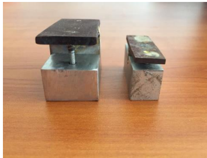
Gambar 3.8 Alat pressing yang terdiri dari cetakan pressing dan batang penekan.
