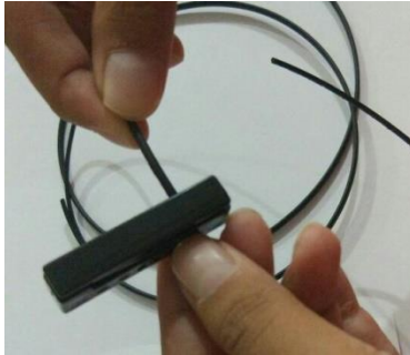
Gambar 3.2 Proses pemotongan serat optik
