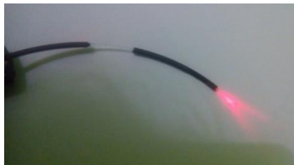
Gambar 3.4 Hasil serat optik yang telah dihilangkan bagian coating -nya
