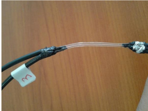
Gambar 4.5 Hasil fabrikasi directional coupler pada panjang kupasan 20 mm untuk massa beban 371.39 gram
