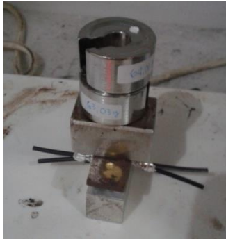
Gambar 4.4 Proses pengandengan serat optik
