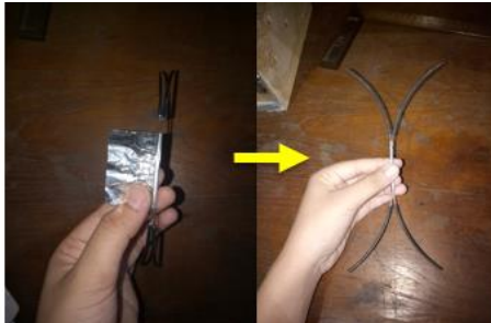
Gambar 3.7 Serat optik yang dibungkus menggunakan aluminium foil
