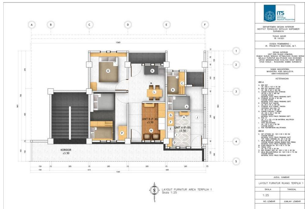
Gambar 5.4 Layout terpilih keseluruhan lantai 2,3, dan 4
