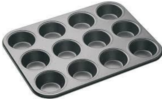
Gambar 3. 5 Cetakan untuk Spesimen Artificial Aging
