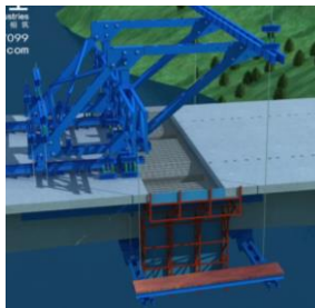
Gambar 7.24 Tahap Pengerjaan Closure
