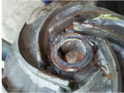
Gambar 4.4 Sudu Impeller yang tidak rata buatan mekanik sendiri
