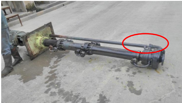
Gambar 4.7 Pompa yang diangkat karena Line Discharge tersumbat
