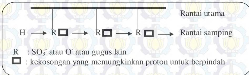
Gambar 2.1 Skema Perpindahan Proton Pada Polimer PEM
