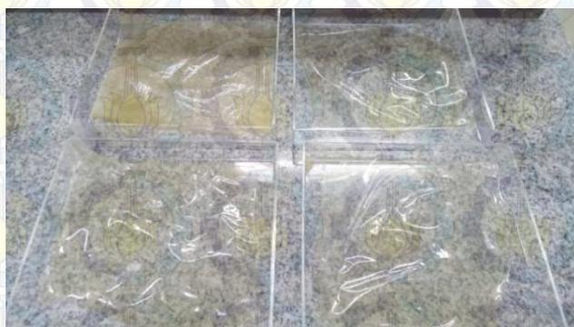
Gambar 4.6. Proses Pencetakan dan Pengeringan Membran
