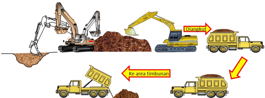
Gambar 4.1 Siklus Pekerjaan Galian Tanah
