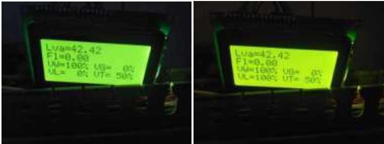
Gambar 3.12 Tampilan LCD saat bukaan valve 0% dan 100%
