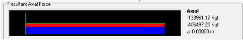
Gambar 8. 18 Gaya Aksial yang Terjadi pada Kolom Atas
