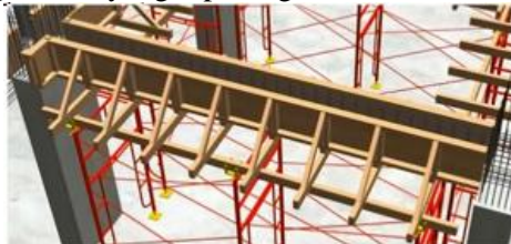
Gambar 10. 4 Balok Siku pada Bekisting Balok
