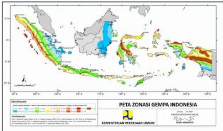
Gambar 3. 4 Peta respon spectra percepatan 1.0 detik (S1) di batuan dasar (SB) untuk probabilitas terlampaui 2% dalam 50 tahun
