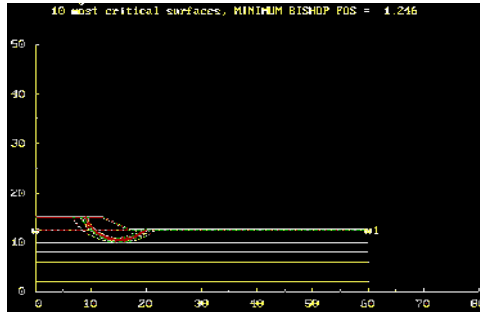
Gambar 5. 11 Analisa timbunan kemiringan lereng 1:2 tinggi 4,3m
