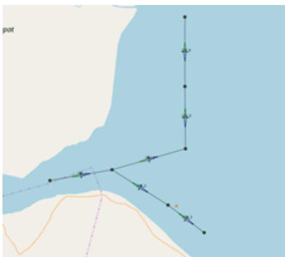
Gambar 4. 5 Leg yang dibuat untuk menghitung besarnya frekuensi tubrukan
