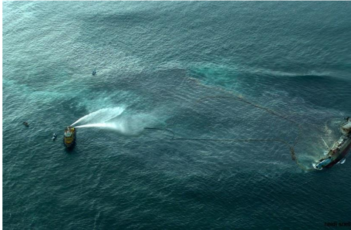
Gambar 2. 12 Proses Penanggulangan dengan Dispersan (NOAA, Deepwater Horizon Oil SPill, 2018)
