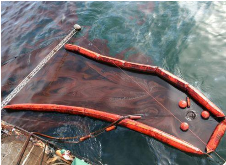
Gambar 2. 10 Penggunaan Booms untuk Membatasi Tumpahan Minyak (NOAA, General NOAA Operational Modeling Environment (GNOME) Technical Documentation, 2012)
