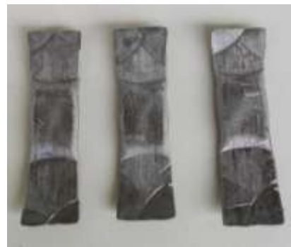
Pengeluaran hasil sintesis MgB_2 dari tabung SS 304
