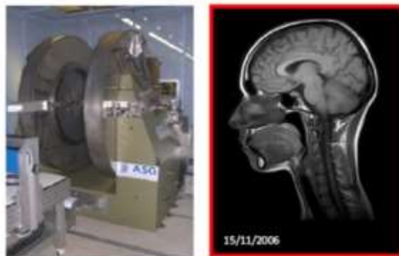
Gambar 2.12 Magnetic Resonance Imaging (MRI) berbasis MgB_2 (kiri) dan citra otak pertama yang diperoleh MRI dengan basis MgB_2 (kanan) (Razeti, 2008)
