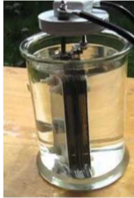
Gambar 2.11 Generator HHO Tipe wet cell[5]
