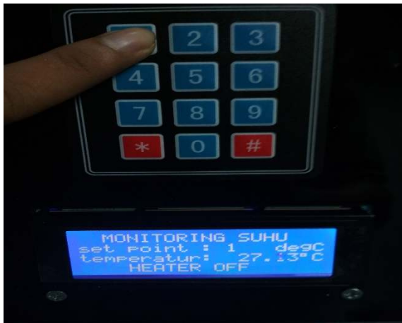
Gambar 4.2 Pengujian Rangkaian Keypad dan LCD
