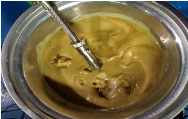
Gambar 4.10 Lilin Batik dengan Temperatur 50°C
