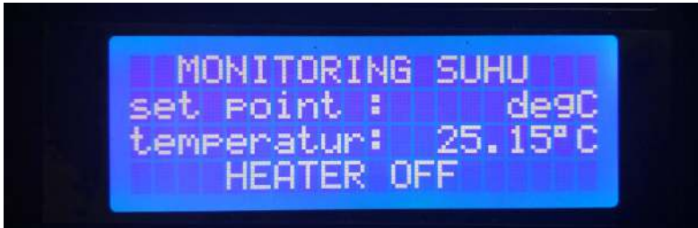
Gambar 4.7 Tampilan LCD Saat Pertama Kali Dihidupkan
