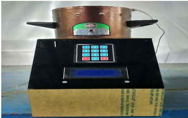
Gambar 3.16 Mekanik Kompor Listrik Batik Tulis
