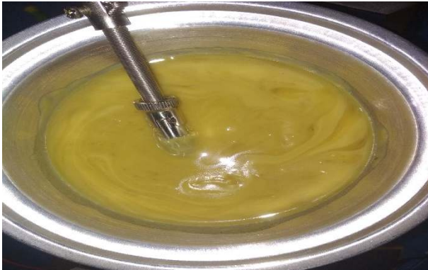
Gambar 4.11 Lilin Batik dengan Temperatur 60°C
