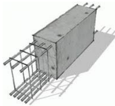
Gambar 3: Bentuk Balok Bertulang Biasa (sumber: http://www.bumibajasakti.com/baja-vs-beton/ )
