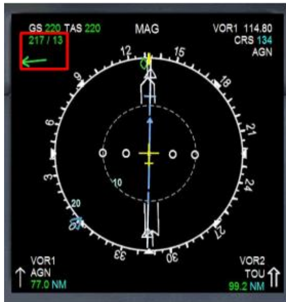
Gambar 2.9 : Indikator arah angin pada board cabin pesawat Ditandai dengan kotak merah (IVAO, 2015)
