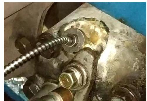
Gambar 6. Pemasangan sensor combustion analyzer kepada kepala silinder
