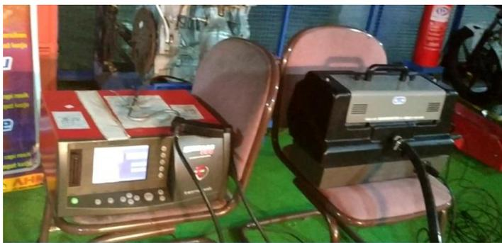
Gambar 5. Pengukuran emisi dengan Gas Analyzer dan Smokemeter
