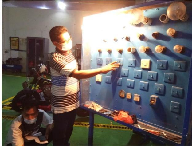
Gambar 2. Pengukuran performa mesin dengan pembebanan lampu
