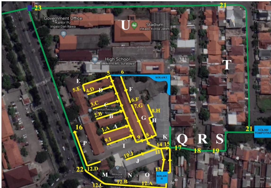
Gambar 4.2 Skema eksisting jaringan Saluran (titik kontrol)
