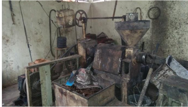
Gambar 4. 1 Proses Pengepresan Biji Nyamplung ( Calophyllum inophyllum L )
