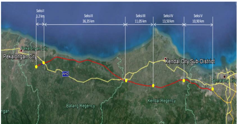
Gambar 4.3 Pembagian Seksi Konstruksi Perencanaan Jalan Tol Semarang-Batang
