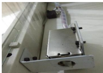
Gambar 3.39 Pintu Terkunci Door Lock
