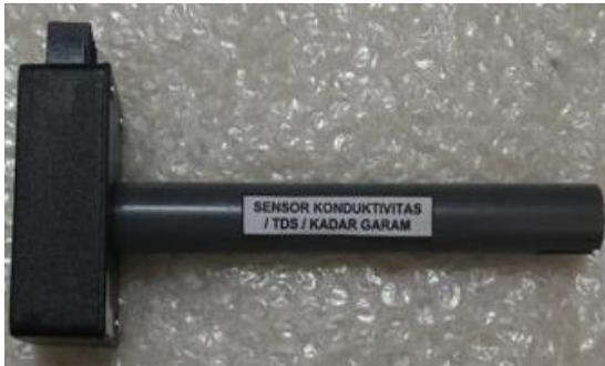
**Gambar 2.6** Sensor konduktivitas / TDS / kadar garam
