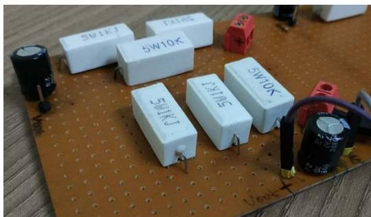
**Gambar 3.8** Rangkaian Pembagi Tegangan
