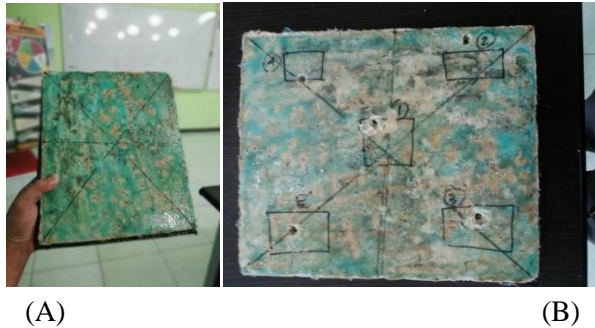
(A) Panel Sebelum di Tembak (B) Panel Sesudah di Tembak Gambar 4.7 (A) Panel Sebelum di Tembak (B) Panel Sesudah di Tembak
