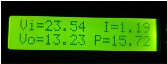
**Gambar 4.8** Tampilan Monitoring Tegangan Baterai di LCD 16x2
