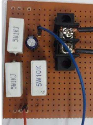
**Gambar 3.13** Rangkaian Pembagi Tegangan Keluaran *Charge Controller*
