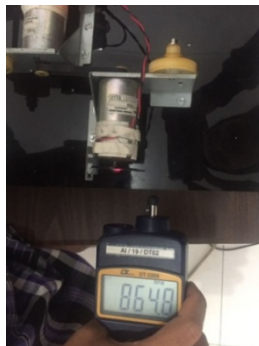
Gambar 4.32 Pengukuran Kecepatan Menggunakan Tachometer
