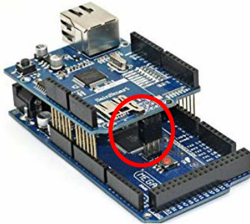
Gambar 3.9. Koneksi Ethernet Shield Pada Arduino
