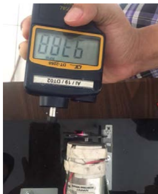
Gambar 4.27 Pengukuran Kecepatan Menggunakan Tachometer
