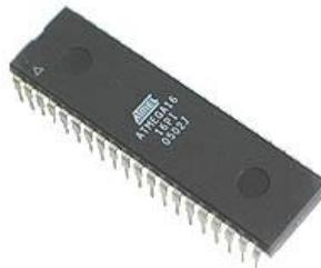
Gambar 2.5 Mikrokontroler AVR ATmega 16
